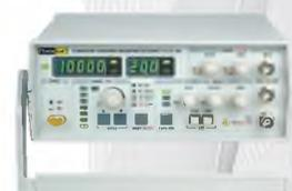
**ПрофКип ГЗ-112М генератор сигналов НЧ**
