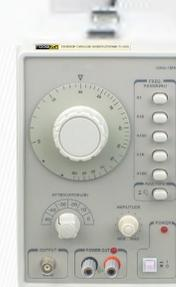
**ПрофКип ГЗ-113М генератор сигналов НЧ**
